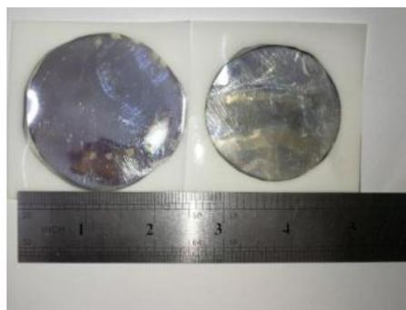
图 3 极化后压电膜样品
