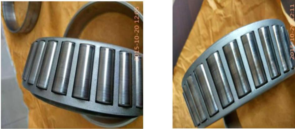
图2 典型 GCr15 轴承钢轴承和新材料轴承台架试样后轴承表明质量，新材料表面质量完好，GCr15 轴承钢轴承表面发黄，表明轴承运转时表面瞬时温度升高到 200 度以上。
