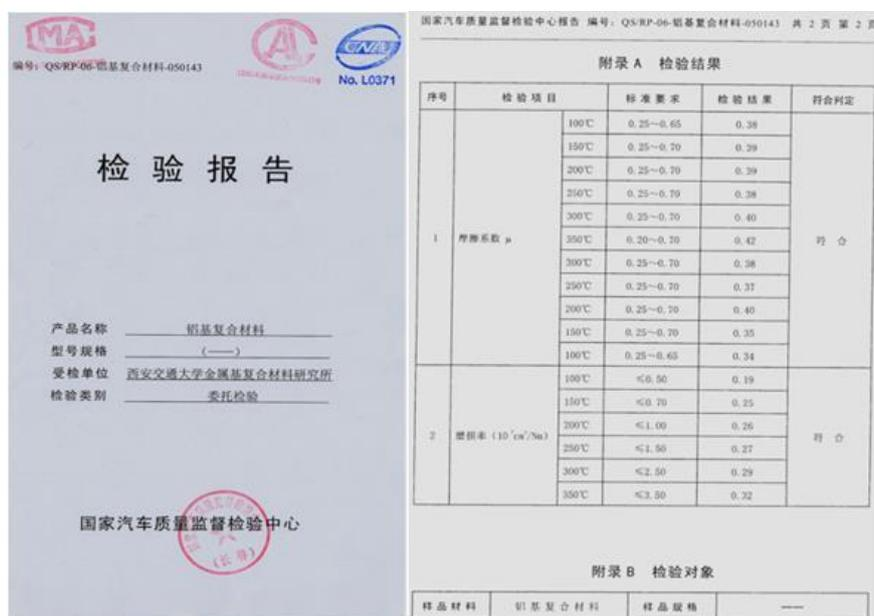
图 10 摩擦系数和磨损率的检测报告
