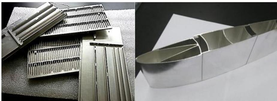
图 7 快离子导电膜处理零部件
