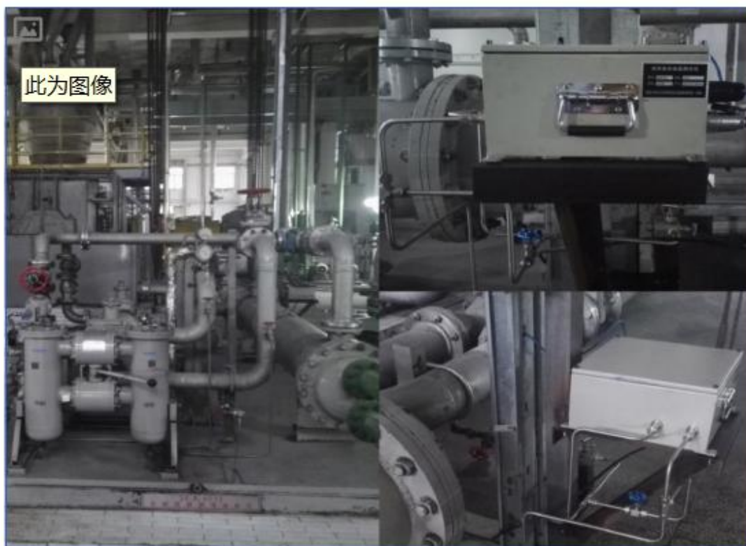
图 6 挤压造粒机的油液集成在线监测系统
