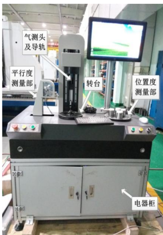
图 1 零件多几何要素在线快速检测仪
