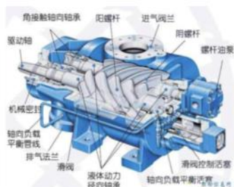
图 5-1 螺旋压缩机外形及内部结构
