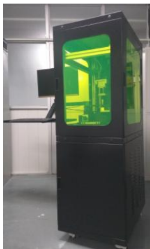
图 4-1 陶瓷光固化面成形自制设备
