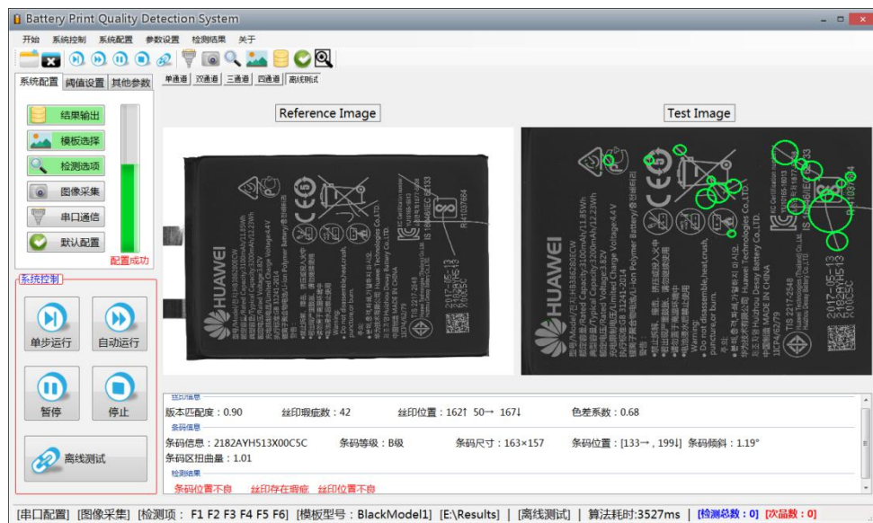
图 1 电池丝印检测系统软件界面及输出结果
